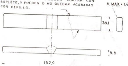
FIG. g-10 ESPECIMENES PARA PRUEBA DE DOBLADO EN LA CARA Y EN LA BASE
