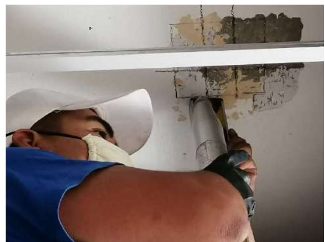
Fotografía r . Realización de prueba de esclerómetro. Nótese seccionamiento del área de ensayo.
