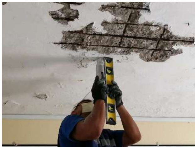
Fotografía q . Realización de prueba de esclerómetro sobre losa del área de Dirección.
