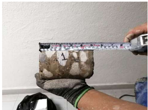
Fotografía p . Medición de parámetros del núcleo de concreto extraído.
