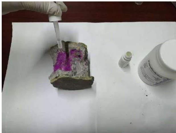
Fotografía s. Realización de prueba de carbonatación a núcleo de concreto. Nótase la pigmentación del concreto.
