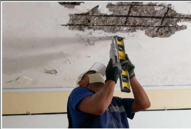
Fotografía 11. Gobierno. Dirección Realización de prueba mediante esclerómetro.
