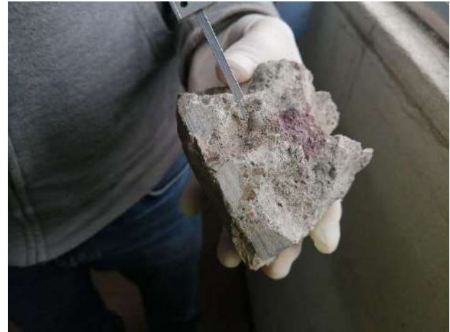
Fotografía t. Realización de prueba de carbonatación sobre fragmento de núcleo. Nótase las áreas pigmentadas y no pigmentadas.
