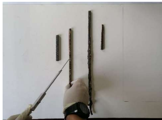
Fotografía v. Realización de pruebas físicas a diversas muestras obtenidas del acero de refuerzo.
