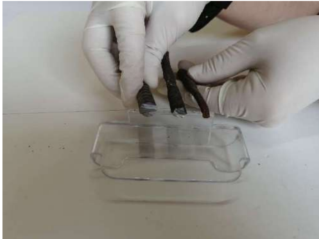
Fotografía w. Medición de la sección de acero reducida en muestras de varillas de acero de refuerzo .
