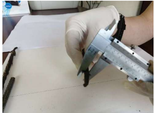
Fotografía x. Medición de una varilla con reducción del 50% de su sección .
