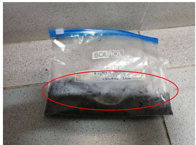
Fotografía m. Nótese condensación de la humedad en la muestra obtenida del material de relleno.
