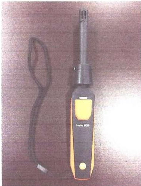
TERMOHIGRÓMETRO, MARCA: TESTO, MODELO: 605i
