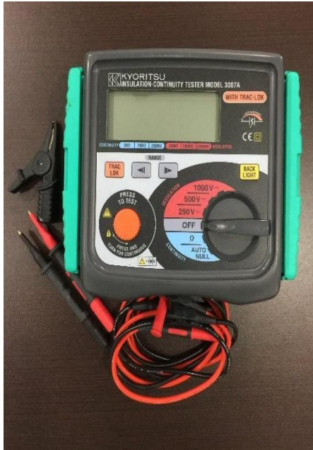
PROBADOR DE CONTINUIDAD Y AISLAMIENTO DIGITAL 250 V/500 V/1000 V, MARCA: KYORITSU, MODELO: 3007A
