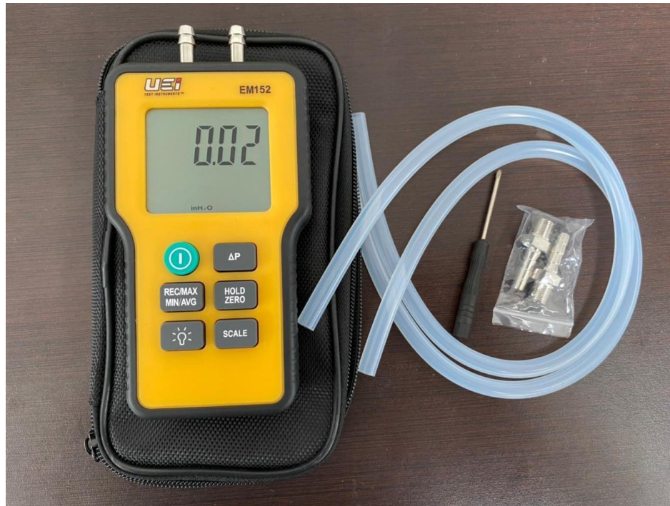
MANÓMETRO DIGITAL DE PRESIÓN DIFERENCIAL DUAL, MARCA: UEI, MODELO: EM152
