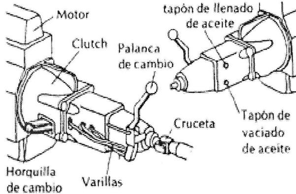
Se usa aceite para transmisión y preferentemente el especificado por el fabricante.
