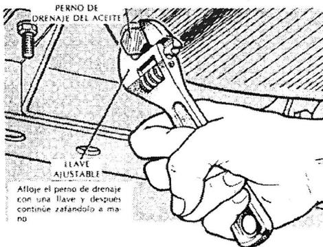
**3.2.- Coladera y juntas.-** en caso de vehículos Volkswagen (sedán, combi, panel, etc.) se coloca un recipiente debajo de los pernos de drenaje, se aflojan estos con una llave de tuercas y se desatornillan con
