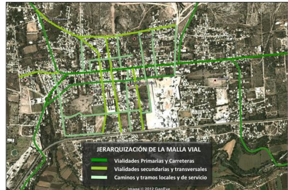
Figura 4. 12 Jerarquización de la malla vial en la zona urbana de Atotonilco de Tula
