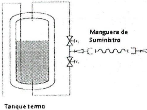
13.- Durante el tiempo de trasvase se deberá estar monitoreando constantemente el nivel del gas criogénico a través de los indicadores de la pipa de suministro y el tanque termo fijo.
