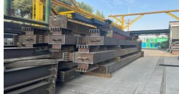
Visita en taller para constatar la fabricación de columnas, conectores y placas metálicas
