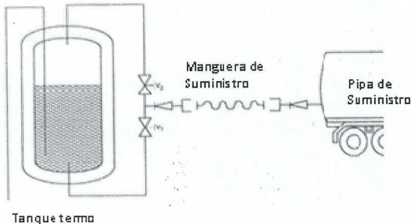
13.- Durante el tiempo de trasvase se deberá estar monitoreando constantemente el nivel del gas criogénico a través de los indicadores de la pipa de suministro y el tanque termo fijo.
