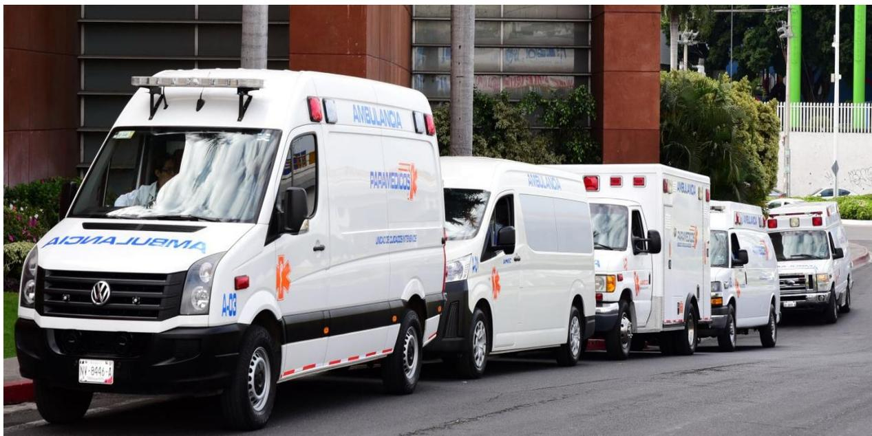
**2.3.3** Las unidades terrestres móviles tipo ambulancia de AMEC® cuentan con un sistema de iluminación de advertencia, a base de lámparas que emiten luces rojas y blancas de forma intermitente sobre el toldo, con proyección de 360 grados y visibles a una distancia de 150 metros, conforme al numeral 5.2.1 de la NOM-034-SSA3-2013.
